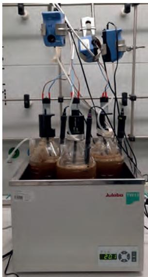
La respirometria viene utilizzata anche per il cosiddetto frazionamento del COD, ovvero per suddividere il COD totale in ingresso impianto nelle frazioni solubile e particolata, distinguendo fra la quota di materiale biodegradabile e la quota inerte (Fig. 12.5). Ciò consente di avere un'idea di base sulla quota di COD che sarà possibile abbattere per via biologica, considerato che la quota inerte rimane sostanzialmente inalterata nei processi a fanghi attivi.
