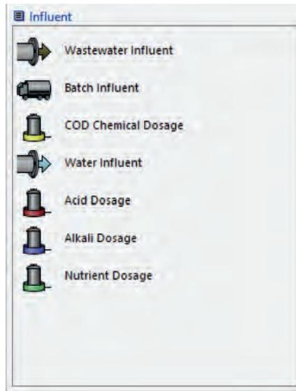
L'oggetto 'refluo in ingresso' (*wastewater influent*, Fig. 6.2) è utilizzato per rappresentare flussi continui in ingresso impianto derivanti dalla rete fognaria; è possibile specificare la portata mediante dataset (da file oppure
