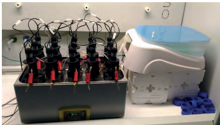
Fig. 10.2. Esempio di strumentazione per l'esecuzione della prova BMP (test biologico).
