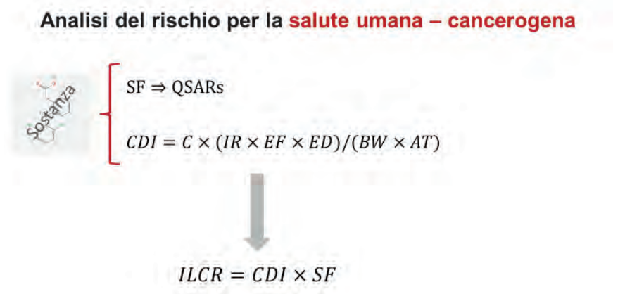
Fig. 3.5. Analisi del rischio per la salute umana: schematizzazione del calcolo dell'indice di qualità tossicologica cancerogena.
