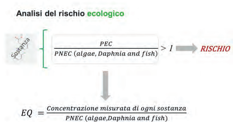
Fig. 3.2. Analisi del rischio ecologico: schematizzazione del calcolo dell'indice di qualità eco-tossicologica.
